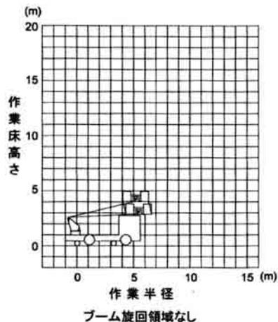
●作業範囲図(ジャッキ接地時)
