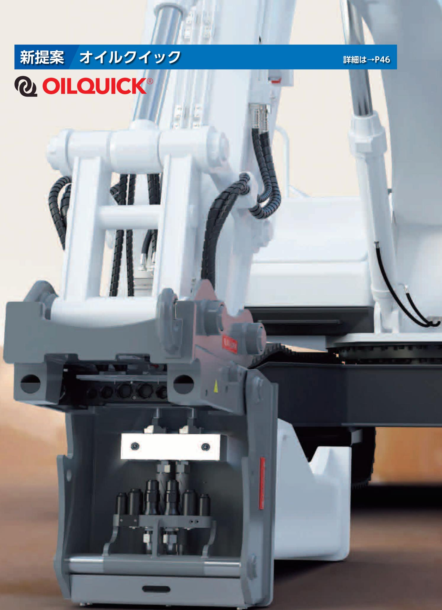
オイルクイックは、運転席に座ったままで、油圧アタッチメントを交換できる油圧ショベル用のオートマチッククイックカプラーシステムです。オペレーターは、わずかな時間で、様々なアタッチメントを交換することができるので、いつでも作業に最適なアタッチメントを使用できます。
