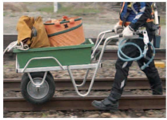
軌道用の車輪は交換可能です。また、車輪にはベアリングを内蔵し、軌道走行もスムーズです。軌道内作業における運搬効率化、労働災害リスクの低減にも効果を発揮します。
