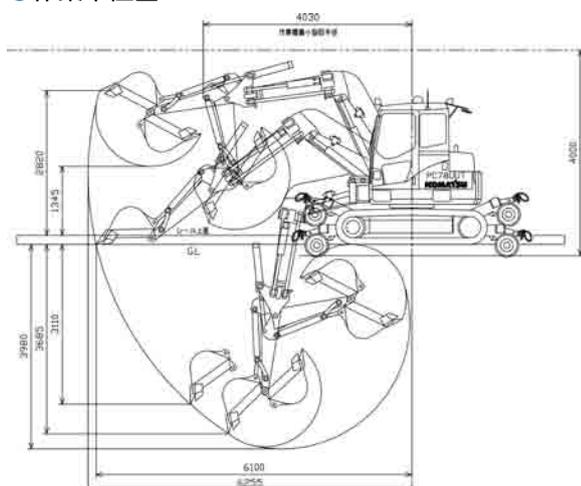
※図は標準バケット装着時の高さ4m制限時の作業範囲です。
